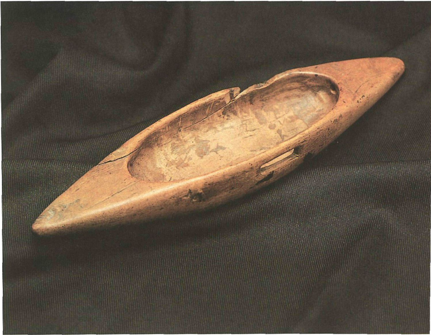
Llançadora manual emprada en el teler artesanal, especialment per a la confecció de teixits de llana i altres fibres gruixudes. (Foto Ernest Esteve.)
