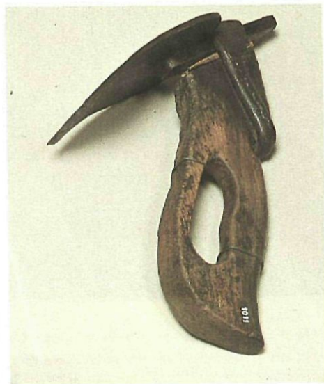
Aixa de fer teies, enginyosa i anatòmica, gràcies a la peça destinada a protegir la mà del llenyataire. (Foto Ernest Esteve.)
